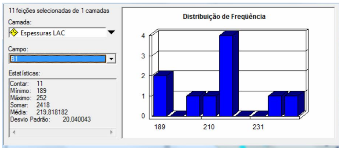
Figura 2.11 – Sumário estatístico e histograma de frequência das espessuras saturadas do Aquífero Superior ou Aquífero Exu.
